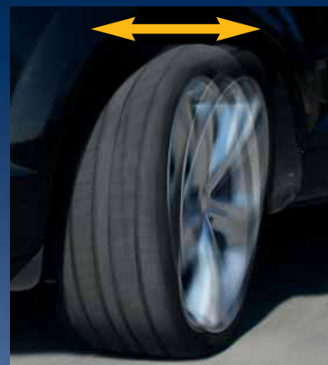
Le défaut d'équilibrage dynamique : la roue à tendance à effectuer un mouvement d'oscillation (shimmy)
