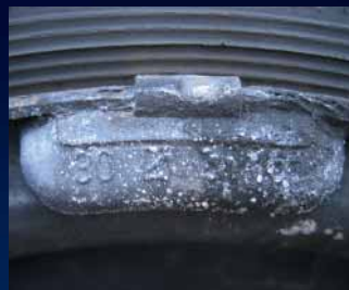
Masses sans revêtement : corrosion de contact de la surface.
