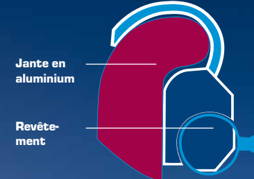
Masses avec revêtement : Surface à revêtement époxy intégral. Épaisseur minimale de 0,1 mm. Env. 5 % de pigments d'aluminium, intégrés à des molécules synthétiques. De ce fait, absence d'oxydation de la surface.
